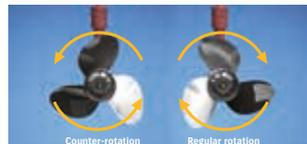
\* Ein spezieller Stecker und ein Zusatzpropeller sind erforderlich, um die Drehrichtung des Außenbordmotors ändern zu können.
