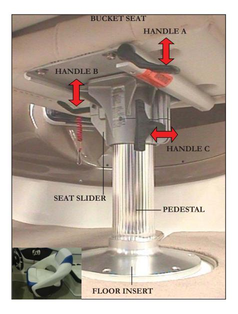
TYPICAL BUCKET SEAT LOCK MECHANISM
