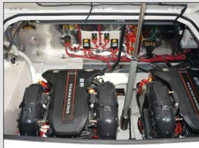
Es sind diverse Varianten möglich. Dabei kommen jedoch immer zwei Volvo-Motoren mit Duoprop zum Einsatz. Als Motorisierung sind entweder 2 x 220 PS (Diesel) oder 2 x 270 PS (Benzin) oder, wie auf unserem Testboot, eine Leistung von 2 x 300 PS (Benzin, Kat, Joystick) vorgesehen. Letzteres ist, wie sich auf dem Wasser zeigte, ein in jeder Hinsicht überzeugende Konfiguration mit einem attraktiven Preis-Leistungs-Verhältnis.
